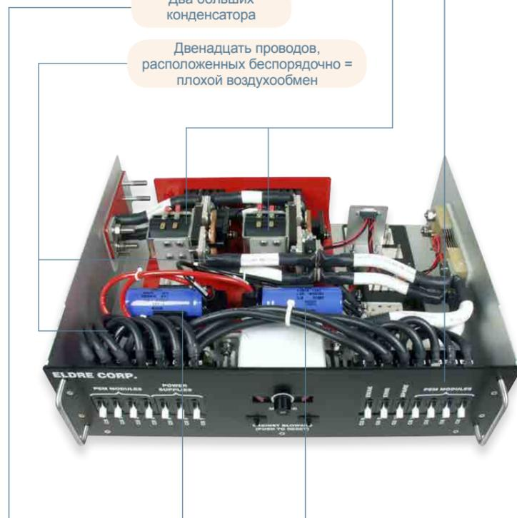
Многослойные шины имеют структурную целостность, которую методы электромонтажа не могут обеспечить. В шины повышенного качества от компании Mersen непосредственно встроено большое количество компонентов. Каждый из них проверен на безопасность и сертифицирован, все комплектующие предназначены для упрощения сборки системы.
