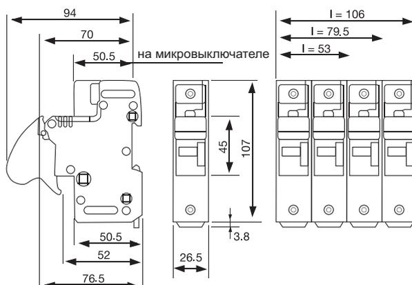
Держатель и разъединитель предохранителя US22, соответствует МЭК при 750 В AC 730 В DC, UL при 800 В AC и 1000 В DC
